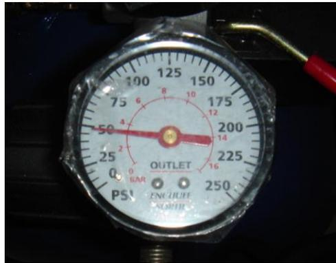
**Fotografía 4.1.-** Manómetro del compresor.
