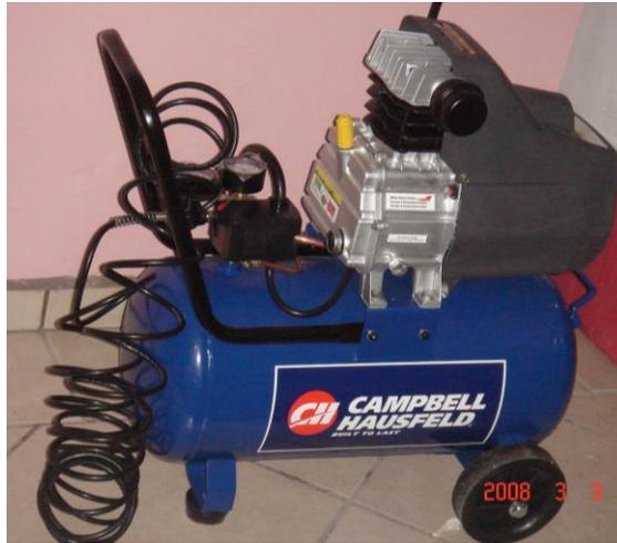
**FOTOGRAFÍA 3.2.-** Compresor de aire usado en las pruebas al prototipo.
