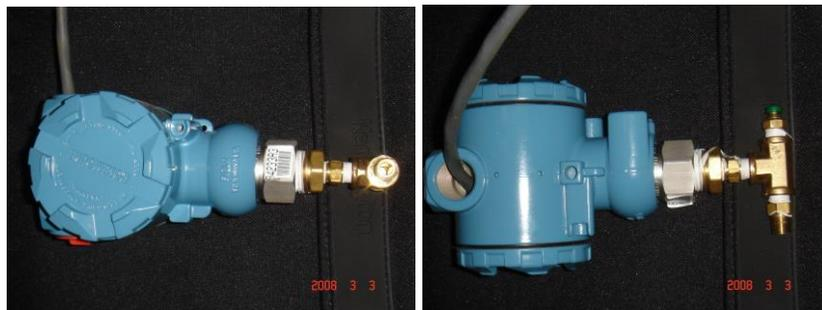
**Fotografía 4.2.-** Transmisor de Presión Rosemount modelo 2088.
