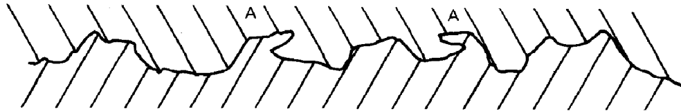
Figura 1.9 Unión mecánica formada cuando un polímero líquido moja una superficie sólida rugosa. [Hull, 1987]
