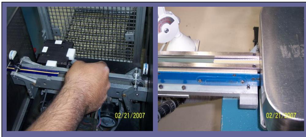
BANDA TRANSPORTADORA PARA ENTRAR A DISPOSITIVO DE IMPRESION
