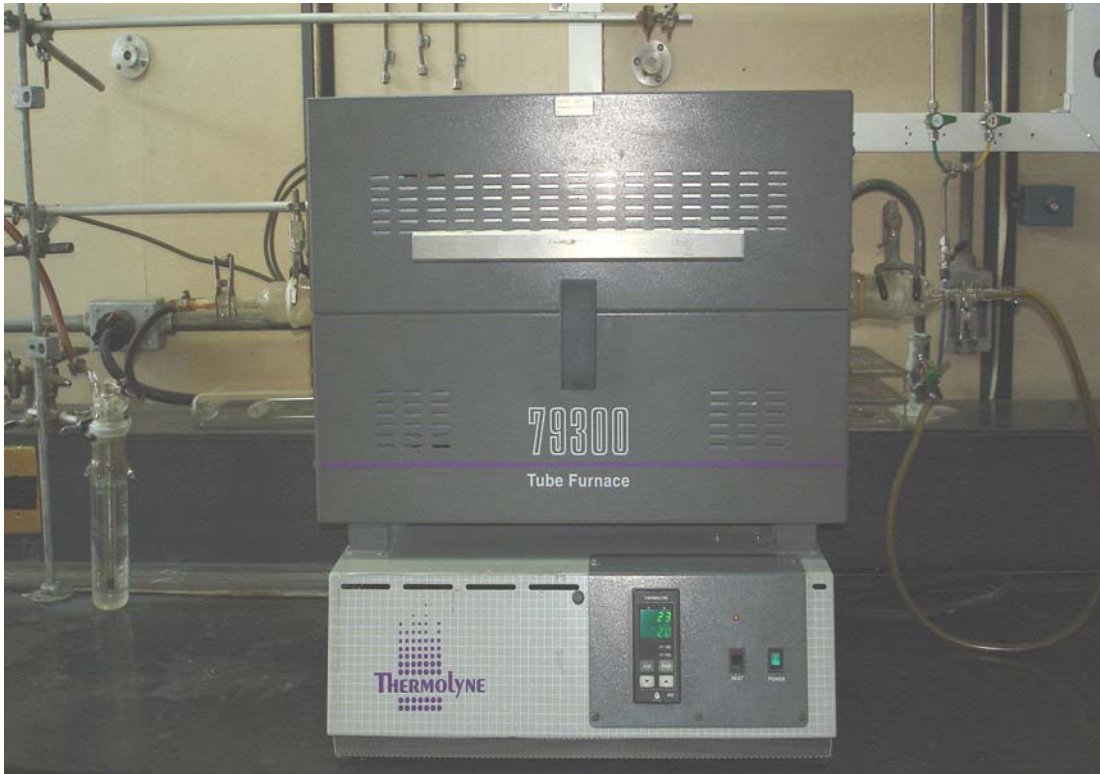
Figura 2.4 Horno tubular empleado para la pirolisis de los materiales mesoporosos.
